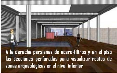
A la derecha persianas de acero-filtros y en el piso las secciones perforadas para visualizar restos de zonas arqueológicas en el nivel inferior
