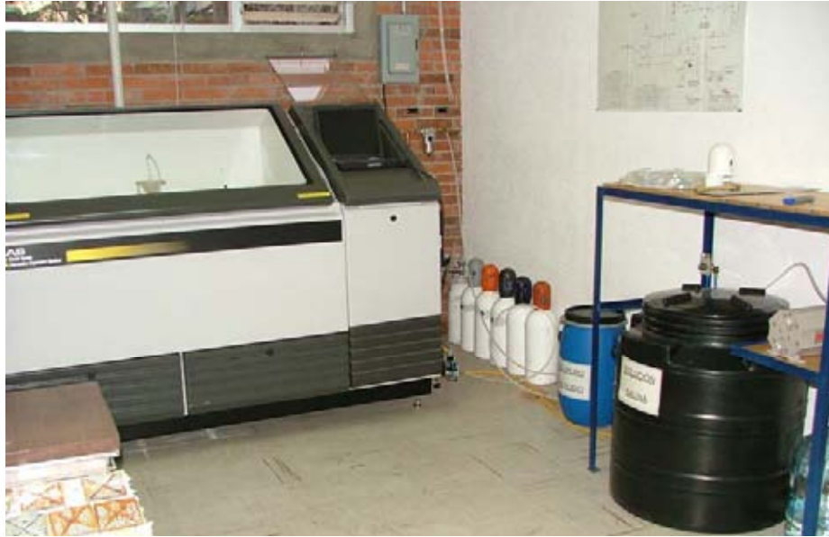
Figura 2.3 Cámara de rocío (niebla) de sal
