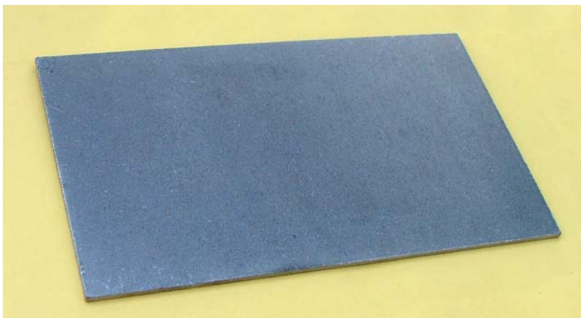
Figura 2.1 Probeta de acero 1010 con limpieza (sand blast) en arena sílica
