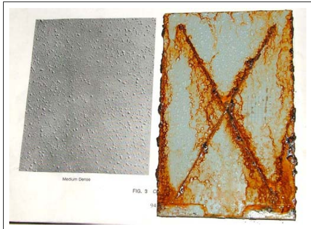
Figura 3.1 Fotografía donde se compara el ampollamiento en el recubrimiento de una de las probetas contra los patrones de referencia de la Norma ASTM D 714
