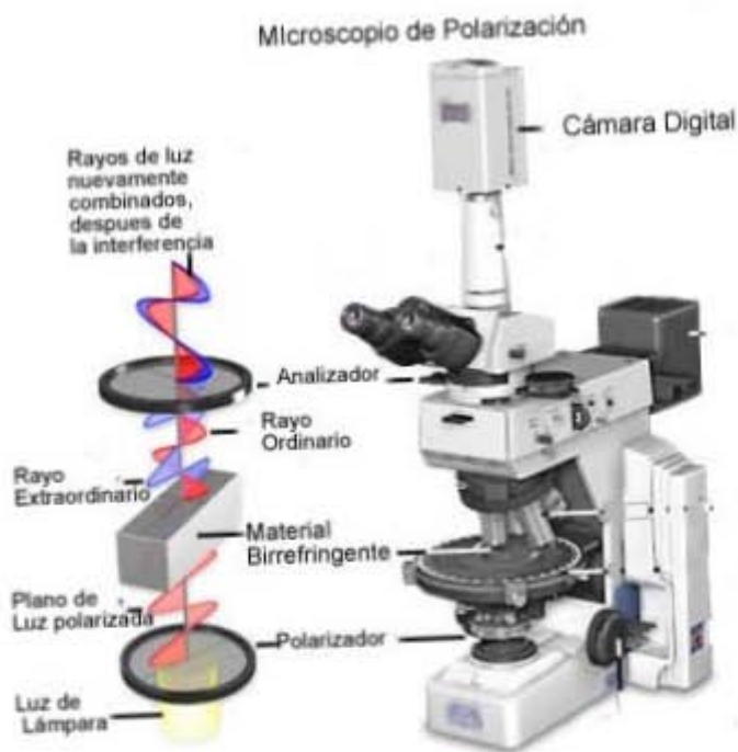
Figura 1. Esquema de cómo viaja la luz en el microscopio de polarización.
