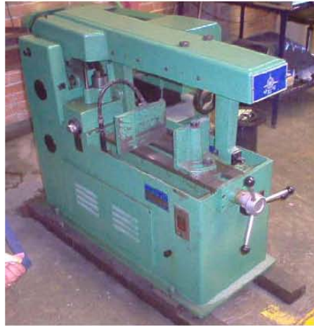
Fig. 2.9 Cortadora Jet 2500 utilizada para el corte inicial de lámina de Mg AZ31.
