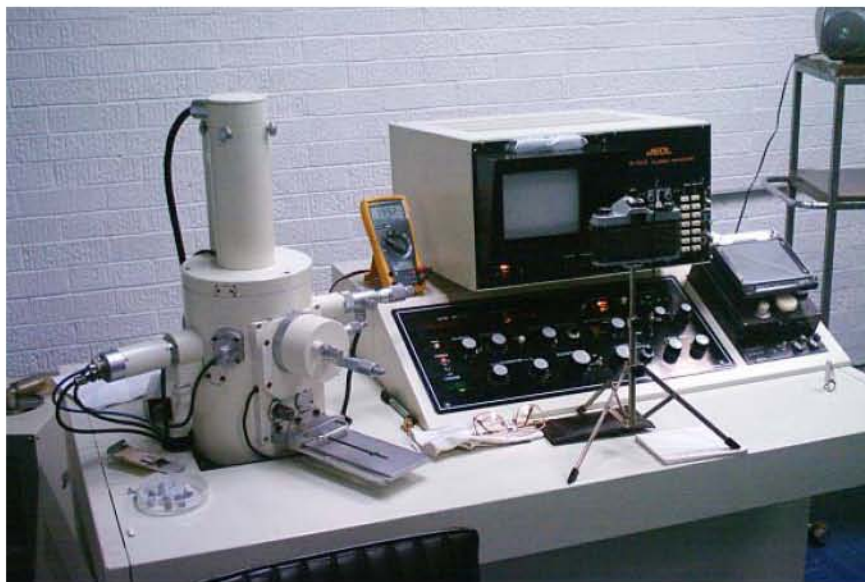
Fig. 2.29 Microscopio Electrónico de columna, JOEL, JSM-255II, utilizado para la microscopía de barrido electrónico, en las probetas.
