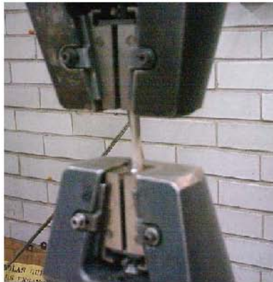
Fig. 2.31 Ensayo de tensión. a) Máquina universal INSTRON 4206 utilizada en el ensayo de tensión. b) Probeta bajo de tensión.
