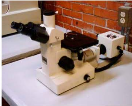
Fig. 2.28 Microscopio IROSCOPE MG-70 utilizado en el análisis superficial de los especímenes en estudio.
