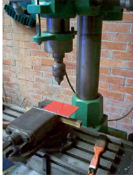
Fig. 2.12 Taladro fresador vertical WT, utilizado para los barrenos de sujeción de las probetas.
