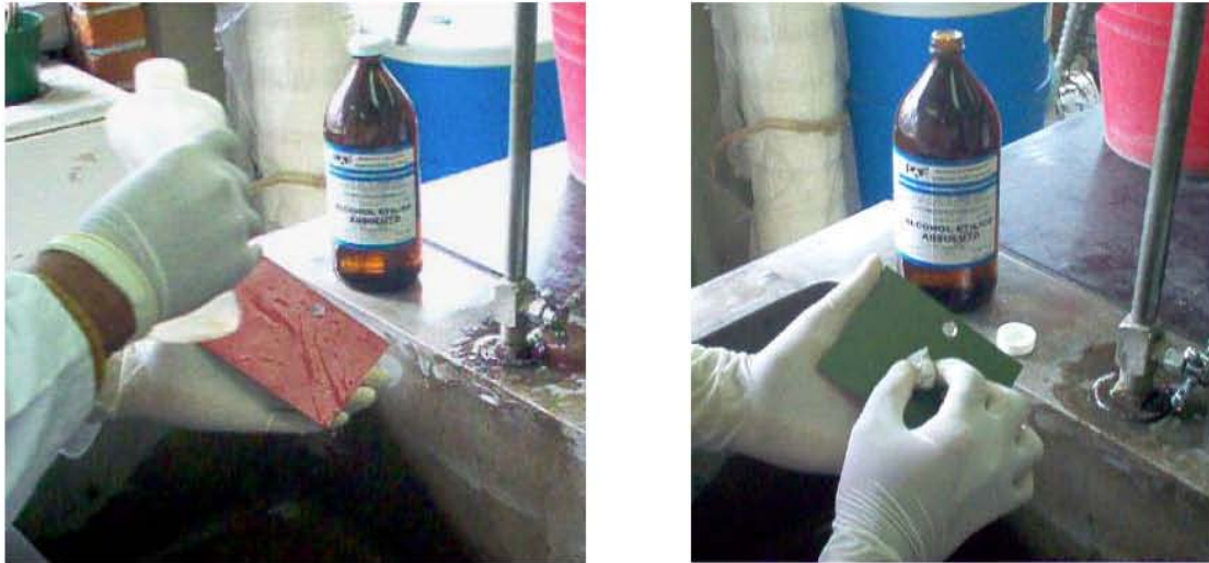
Fig. 2.17 Proceso de limpieza. a) Lavado con agua destilada. b) Limpieza con alcohol grado reactivo.
