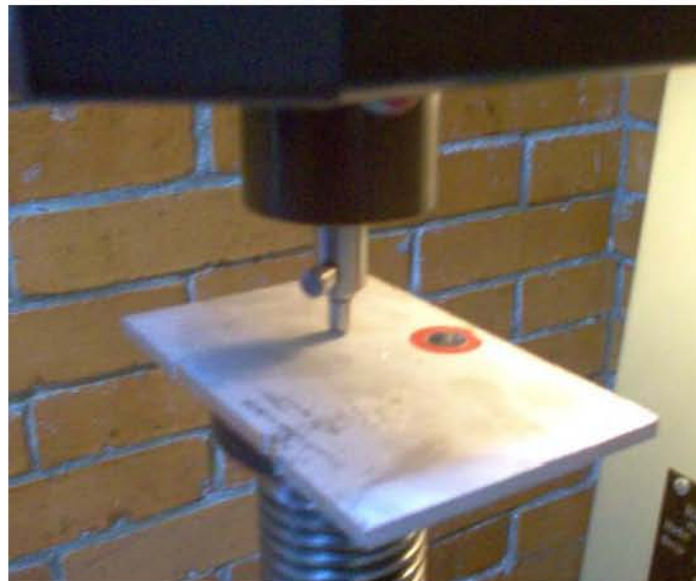
Fig. 3.32 Ensayo de dureza Rockwell F. a) Durómetro Wilson/Rockwell, Hardness Tester, B504-R y equipo de cómputo utilizado para el registro de dureza. b) Probeta bajo Ensayo.
