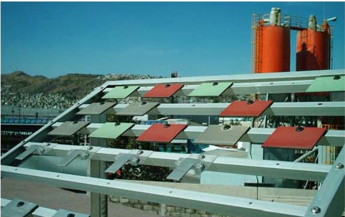
Fig. 2.25 Monitoreo al tercer mes en la estación “Xalostoc”, donde se aprecia el correcto posicionamiento de las probetas y los efectos causados en los recubrimientos de los mismos por los diversos contaminantes de la zona, así como el asentamiento de ellos sobre la superficie de las placas.
