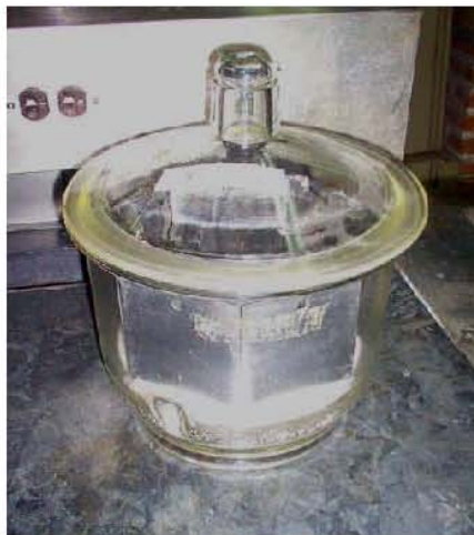
Fig. 2.18 Desecador de calcio utilizado para la deshidratación de las probetas.
