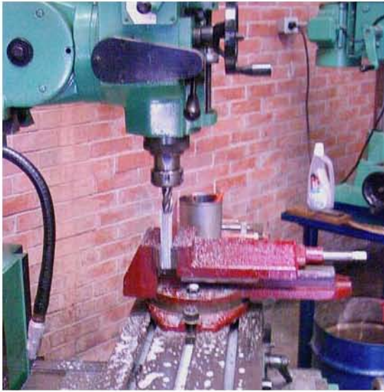
Fig. 2.11 Proceso de rectificación para homogeneización.
