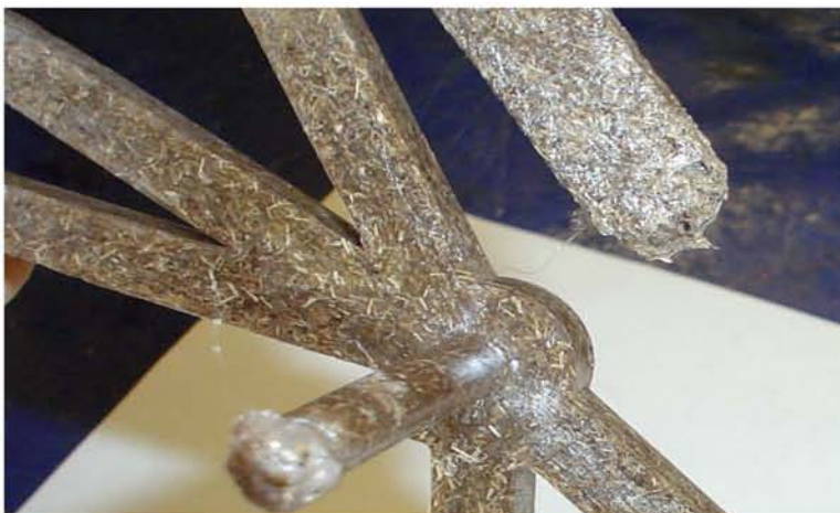
Figura 4.4. Es apreciable la dirección que tienen las fibras a lo largo de la probeta, cumplen con la característica de seguir su trayectoria en el mismo sentido que la inyección.
