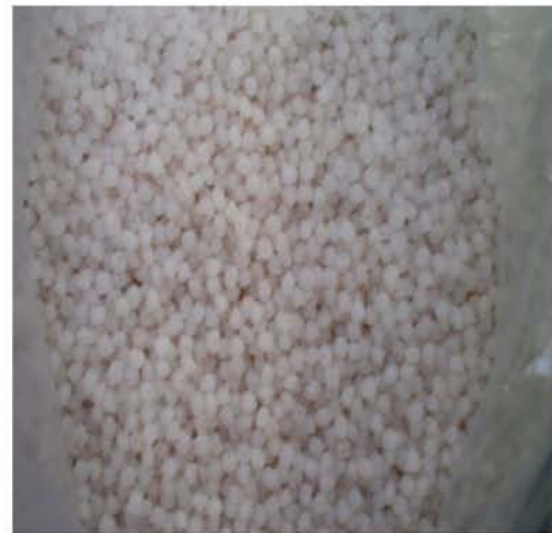
Figuras 3.10 a y b. Mezclas Preparadas antes del proceso de Inyección, se aprecia la concentración de bagazo en ciertas zonas de la mezcla.
