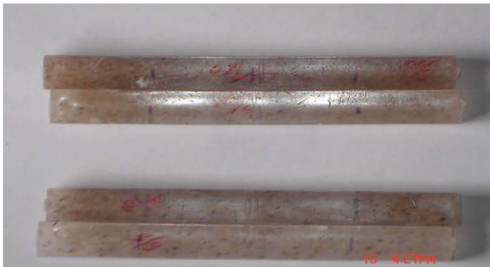
Figura 3.16. Comparación entre muestras del Método A (parte inferior) y el Método B (parte superior), estas últimas presentan menos variaciones dimensionales aunque físicamente son idénticas.
