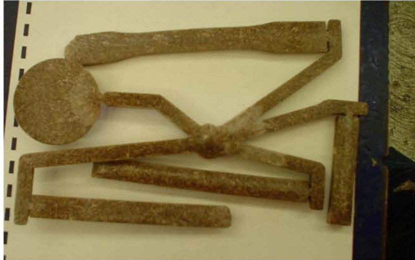
Figura 4.2. Muestra llena al 95% fue necesario monitorear la presión para corregir el problema.
