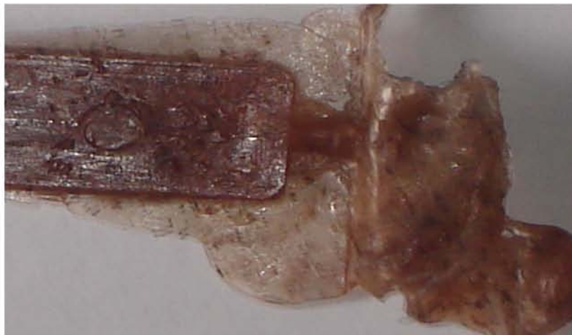
Figura 4.3. Muestra con rebaba, fenómeno que ocurrió para realizar el ajuste correcto de la presión posterior en el proceso de inyección.
