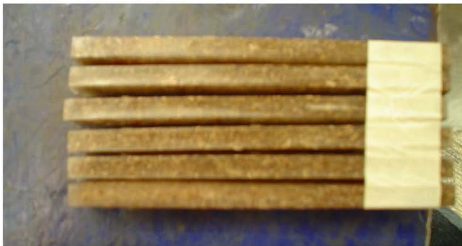
Fig. 4.9. Algunas muestras presentaron cambios en dimensiones durante el proceso, se aprecia esto debido a la falta de acomodamiento entre ellas.
