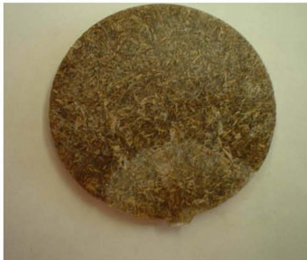
Figura 4.1. Muestra dañada por la variación de temperaturas.
