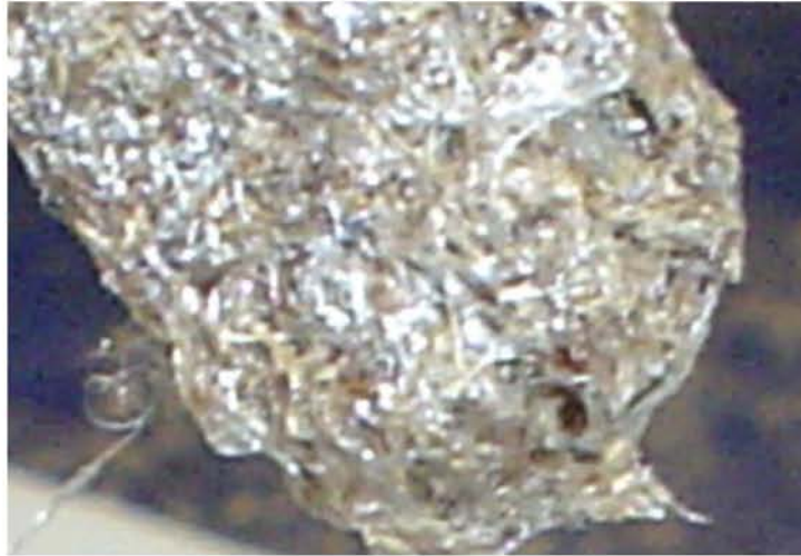
Figura 4.8. La pieza muestra un aparente recubrimiento de la matriz hacia la fibra
