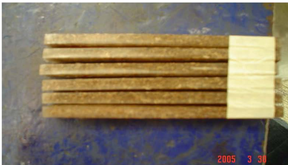
Figura 3.13. Muestras antes del reprocesamiento, se puede observar que en las muestras de la parte superior está presente una variación de dimensión.
