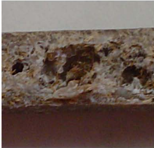
Figuras 4.5 y 4.6. Cortes longitudinal y transversal al flujo. Espacios formados por la permanencia de humedad en las fibras.
