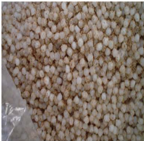
Figuras 3.10 a y b. Mezclas Preparadas antes del proceso de Inyección, se aprecia la concentración de bagazo en ciertas zonas de la mezcla.
