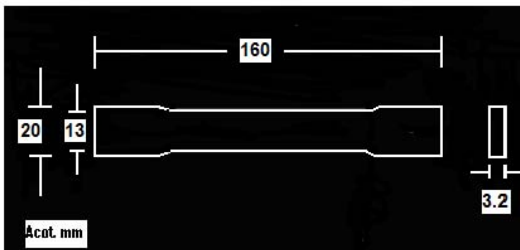
Figura 3.17. Esquema del espécimen requerido para el ensayo de Tracción.
