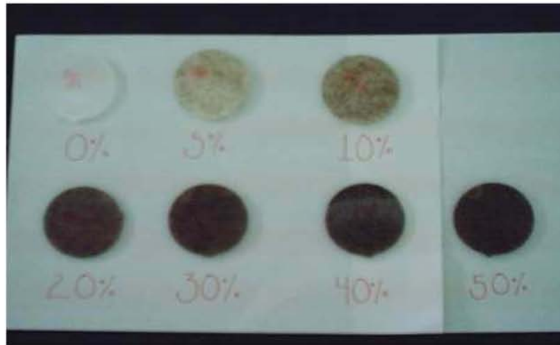
Figura 3.12. Se observa una clara diferencia física de las muestras debido al incremento en el porcentaje de bagazo de caña, conforme aumenta la concentración de bagazo la pieza se vuelve más oscura.
