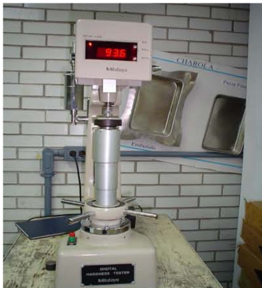
Figuras 3.20 a y b. Ensayo de dureza efectuado en el Durómetro Mitutoyo.
