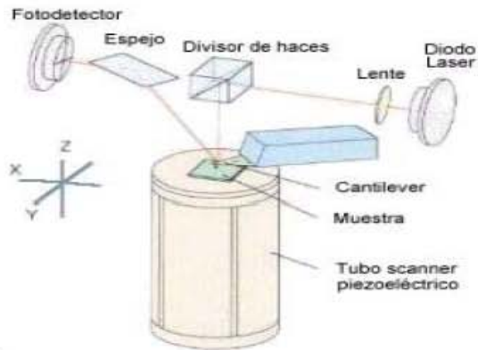
Figura II.15. Funcionamiento del AFM. Fuente: Shimadzu Instruments, 2005.
