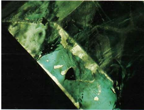
Fotografía 4.4 Desgaste de la sustancia que cubría al berilo y deja al descubierto el tratamiento de recubrimiento, donde se puede observar el color original de la gema verde pálido y un verde esmeralda con el tratamiento. Tomada de Kammerling, Robert C. Koivula, John I. and Kane, Robert E. 1990.
