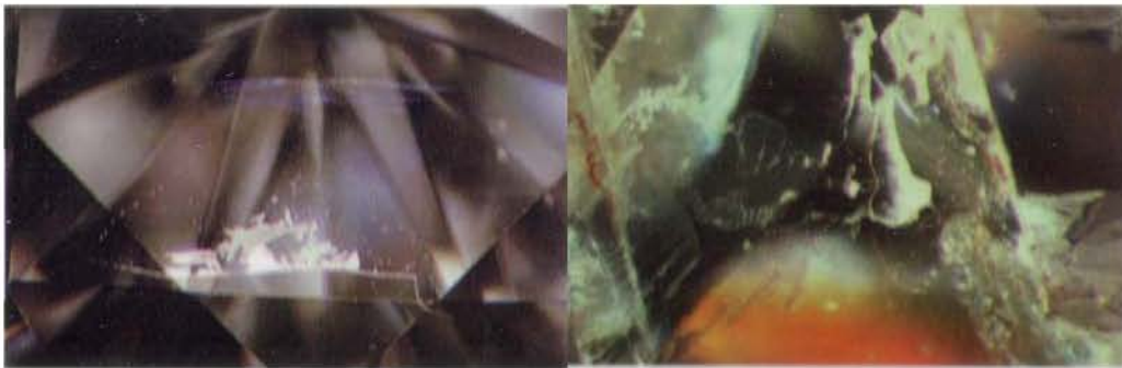
Fotografía 3.9 Estructuras de flujo debido al relleno de fracturas en el diamante, se ven en el fluido como finas líneas apenas visibles (izquierda) e indican el camino que siguió el compuesto, estas estructuras se ven únicamente en pequeñas partes del relleno (derecha). Tomadas de "Identification Of Filled Diamond", GIA.
