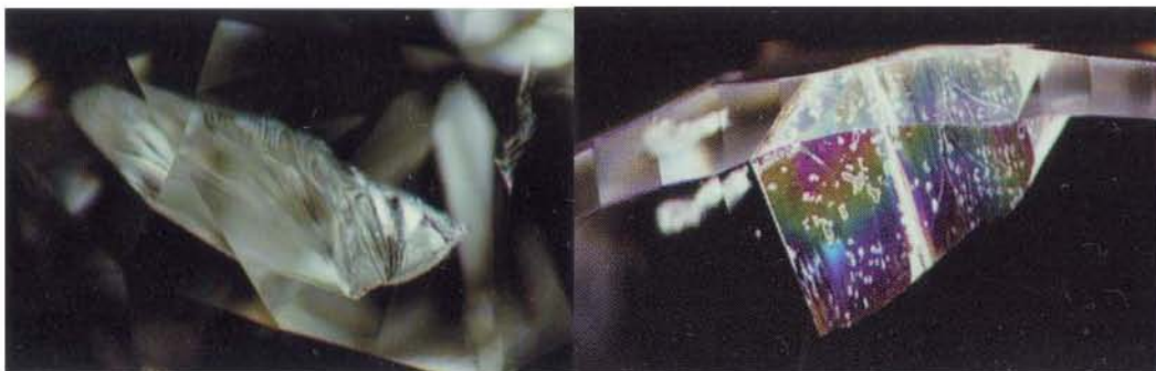
Fotografía 3.8 Diferencia entre fracturas sin relleno a diferencia del efecto flash, en diamantes con fracturas no tratadas es fácil confundir el efecto flash con la iridiscencia que se crea en las fracturas del diamante, se ven una gran variedad de colores (derecha) mientras que en el efecto flash se ve uno o tal vez dos colores en un mismo instante. Otra característica de identificación de que no ha sufrido tratamiento son las fracturas con forma de pluma (izquierda). Tomadas de "Identification Of Filled Diamond", GIA.
