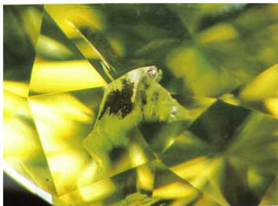
Fotografía 3.3 Grafitización en algunos diamantes debido al proceso de HPHT, debido a las condiciones entre los límites de transición grafito-diamante a las que son sometidos los diamantes Tipo Ia para cambiar su color, aparecen zonas negras cerca de las fracturas. Tomada de McMaclure, Shane F. and Smith Christopher P. 2000.
