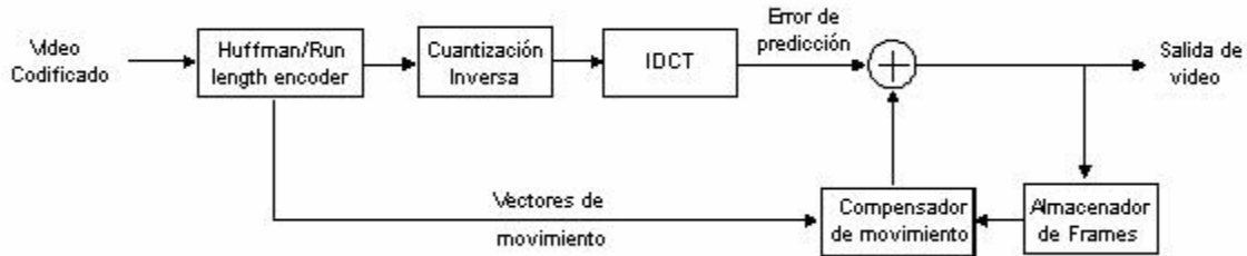
Figura 2.4.4. Diagrama de un decodificador MPEG.
