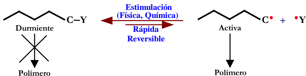
Esquema 4.1. Principio básico en la polimerización radicalica controlada CRP.
