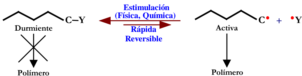
Esquema 2.1. Principio básico en una polimerización radicalica controlada (CRP).
