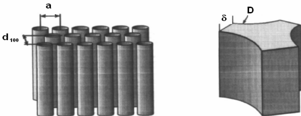
Figura 4.4. Esquema de los parámetros obtenidos por DRX-ab.
