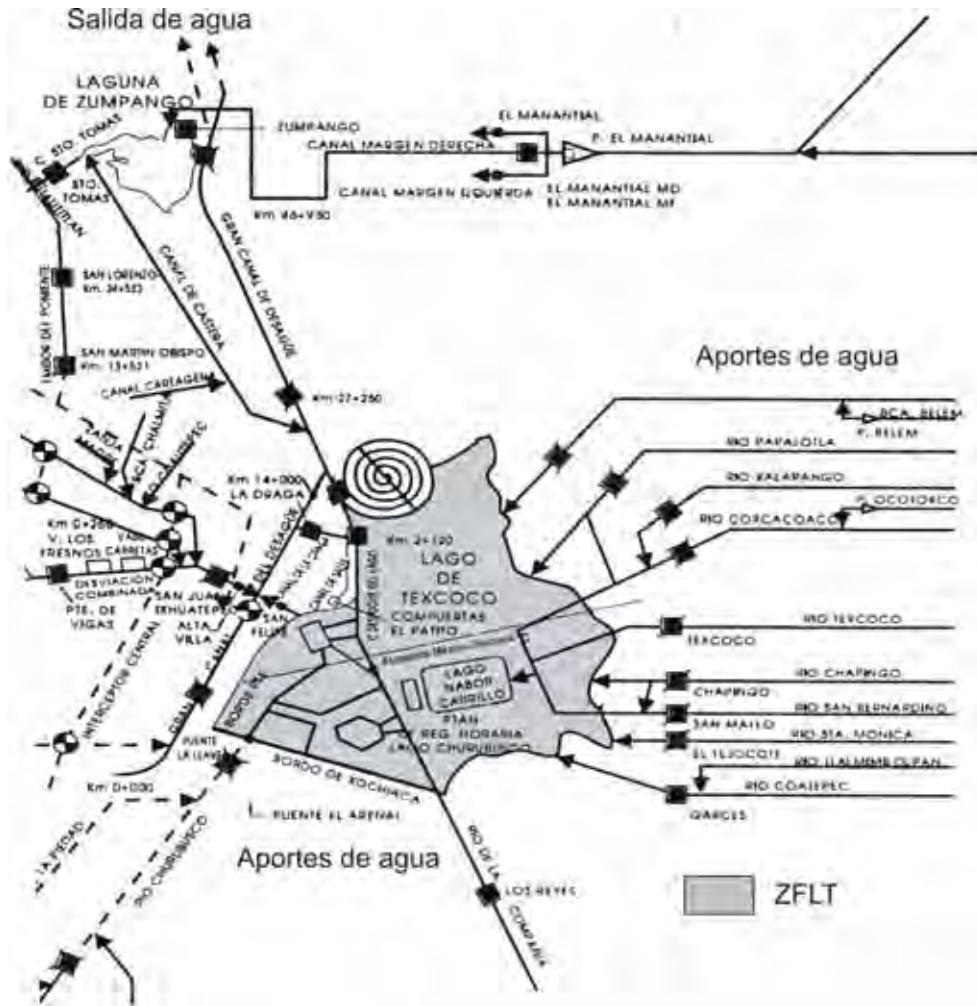
Figura 5.5.- Esquema hidrológico en torno a la Zona Federal del ex Lago de Texcoco. Aportes y salidas de agua (Modificado de Cruickshank, 1995).
