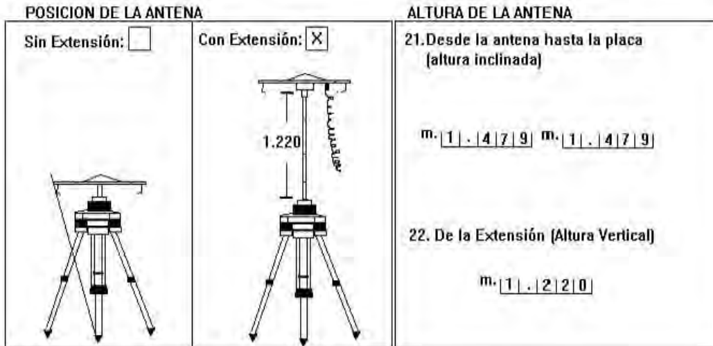
Forma correcta de medir la altura de la antenna con extensión
