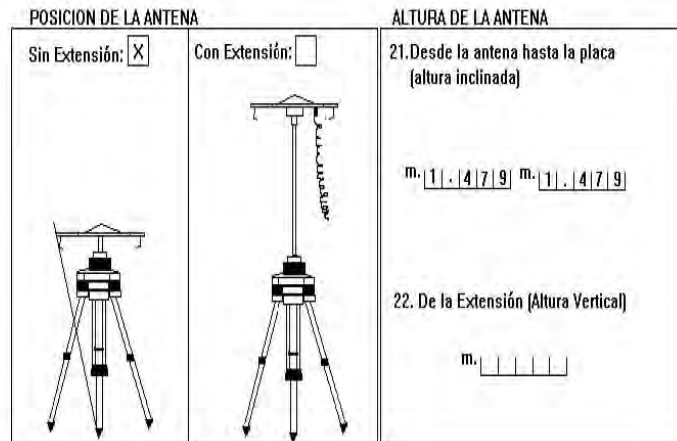
Antena con y sin extensión
