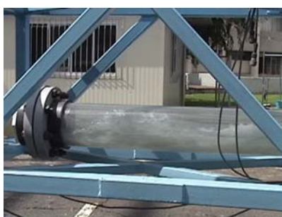
Figura VII.9 Mezcla al 10% en volumen de gas libre.
