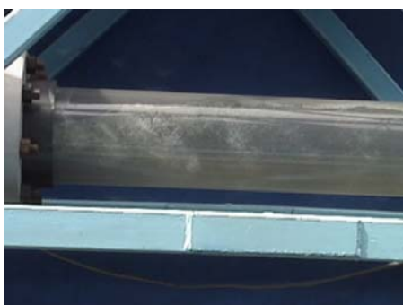
Figura VII.4 Mezcla al 7% en volumen de gas libre
