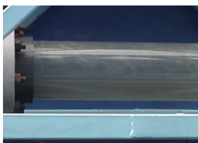
Figura VII.5 Mezcla al 1% en volumen de gas libre
