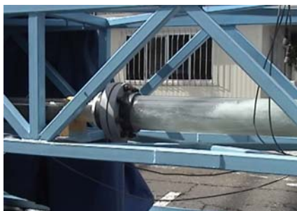
Figura VII.7 Mezcla al 5% en volumen de gas libre.
