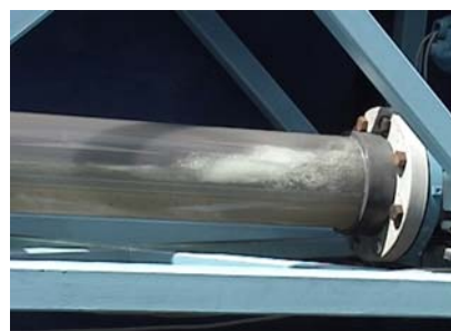
Figura VII.7 Mezcla al 5% en volumen de gas libre.
