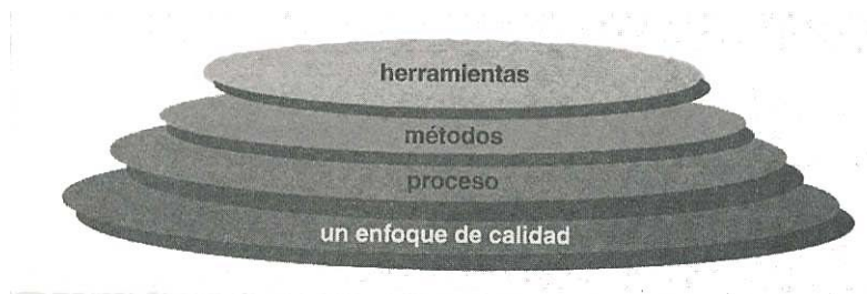
Figura 2.4 Capas de ingeniería del software
