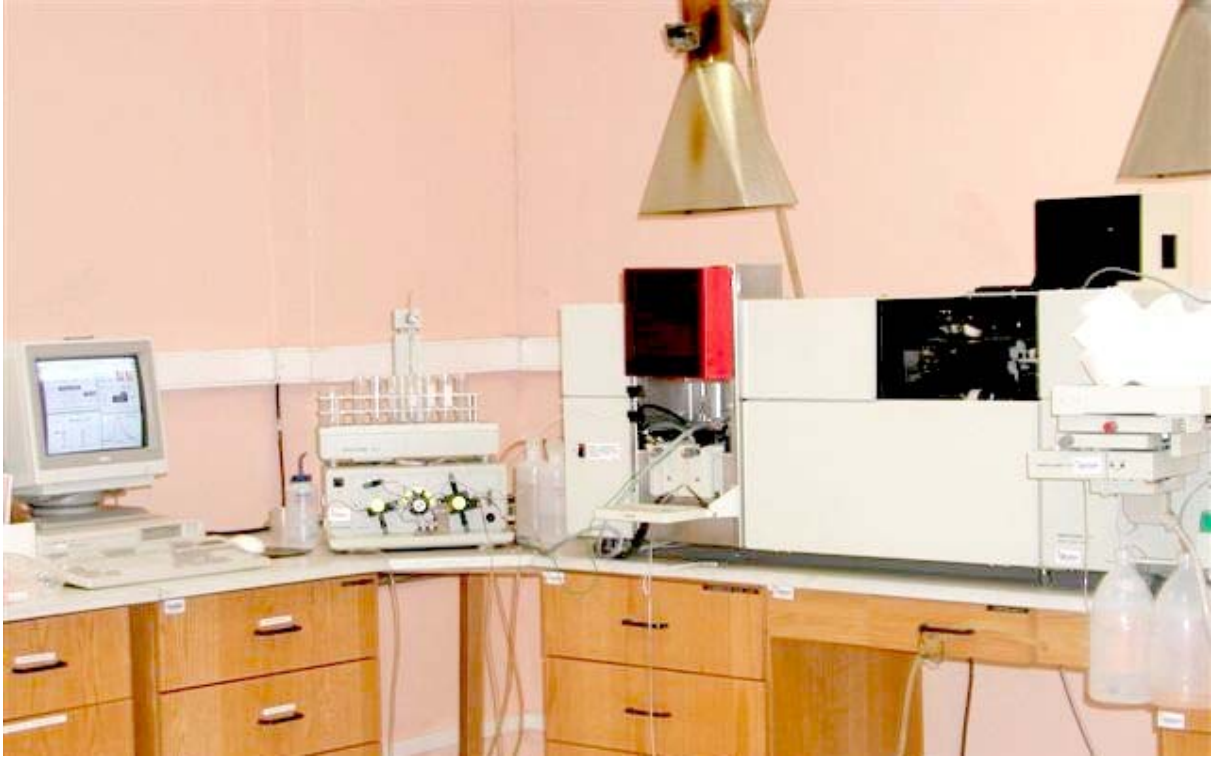
Figura III.7 Espectrómetro de absorción atómica con sistema de inyección de flujo para la medición de mercurio por generación de vapor frío.
