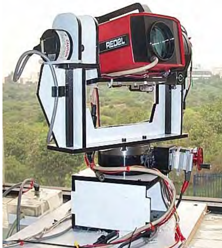
Imagen 10, Temohuani I (Ensamble de EDM y sistema de movimiento).
