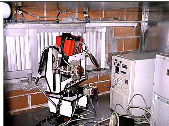
Imagen 11. Detalle sistema de movimiento Temohuani I
