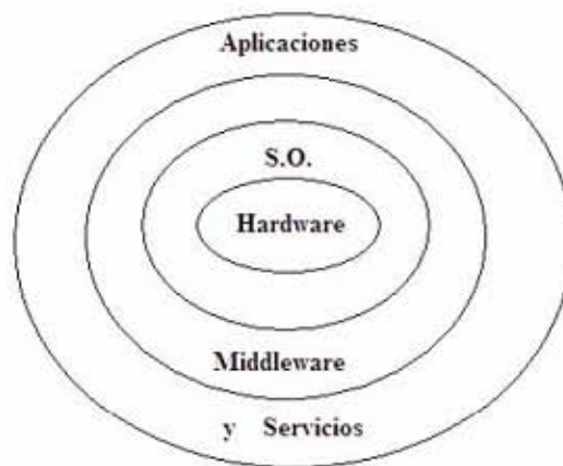
Figura 1.7 Arquitectura de un sistema distribuido
