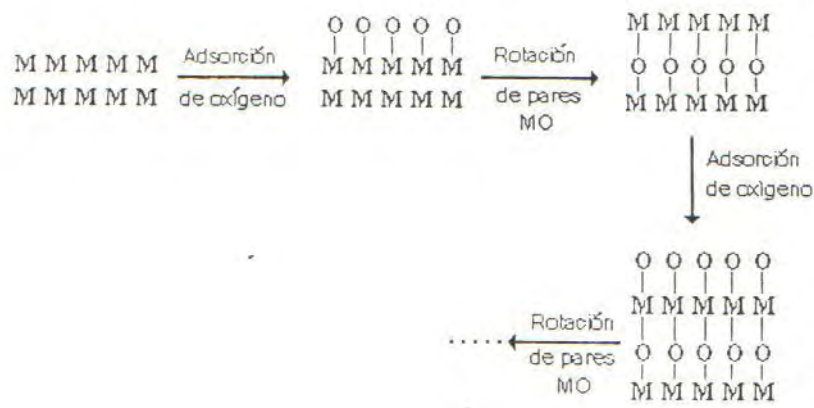
FIGURA 4. Formación de la capa pasiva por intercambio de oxígeno-metal
