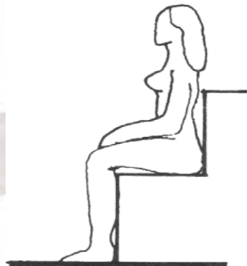
Imagen 55. Profundidad mínima de la superficie de asiento.
