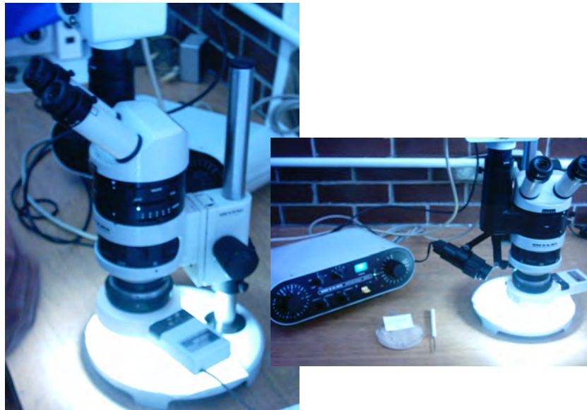
Fotografía 3.1. Microscopio (WILD MPS 515; cámara WILD HEERBRUGG) utilizado para la toma de fotografías de las muestras.
