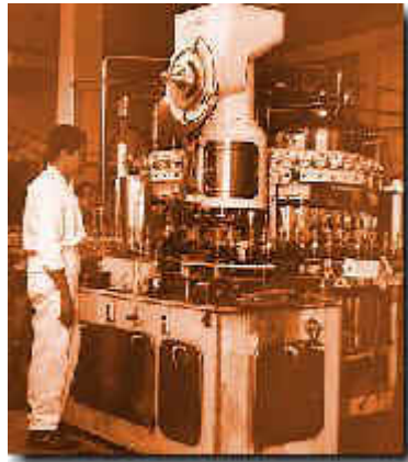
A la izquierda uno de los primeros equipos de embotellado; su capacidad de llenado era de poco más de 5,100 litros por hora. A la derecha una de las modernas llenadoras para envase plástico con capacidad superior a 19,000 litros por hora.
