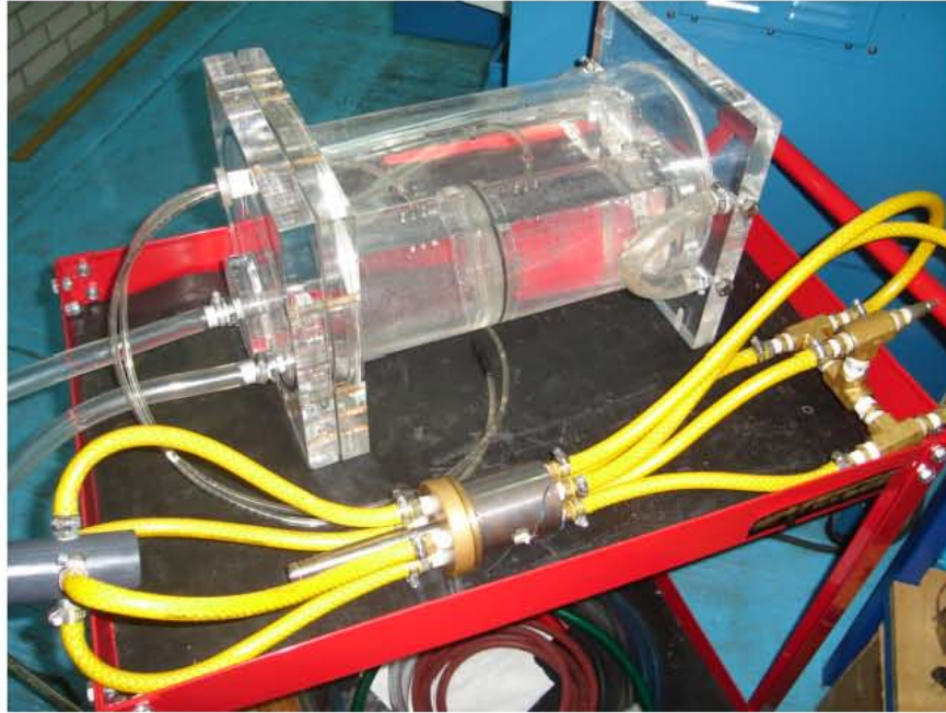
Figura 6.3 Electroválvula y cámara de evaluación.
