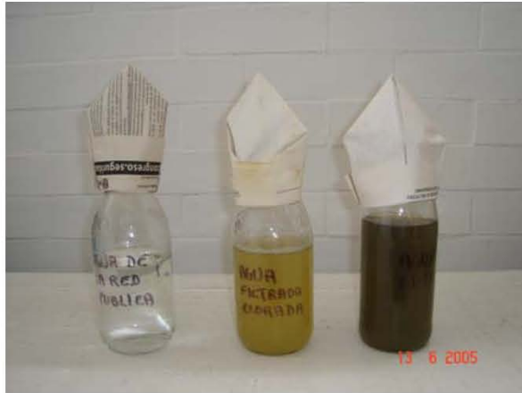
Figura 1.- Muestras del agua utilizada en los tres tratamientos, analizadas bacteriológicamente para hacer la determinación de enterobacterias.
