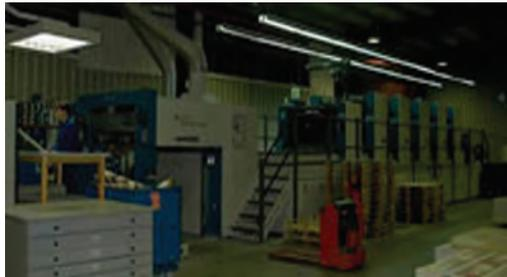
En las máquinas de impresión se llama salida a la recepción del pliego una vez que ha salido del último cuerpo impresor y es transferido a la mesa receptora. Según los modelos de las máquinas la salida puede adoptar diversos aspectos. En máquinas de medida mediana y pequeña la salida se llama de pila baja; en cambio, en máquinas multicolores y monocolors de medida grande, en las cuales la altura suele superar el metro, la salida se denomina de pila alta.
