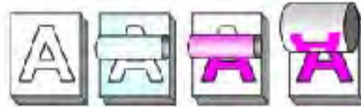
Sobre la forma planográfica se marcan las zonas que serán impresoras con una sustancia que repelerá el agua y recogerá la tinta sustancia.
