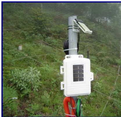
Figura 2.13 Estación Meteorológica Vantage Pro Davis instalada en la parcela experimental.
