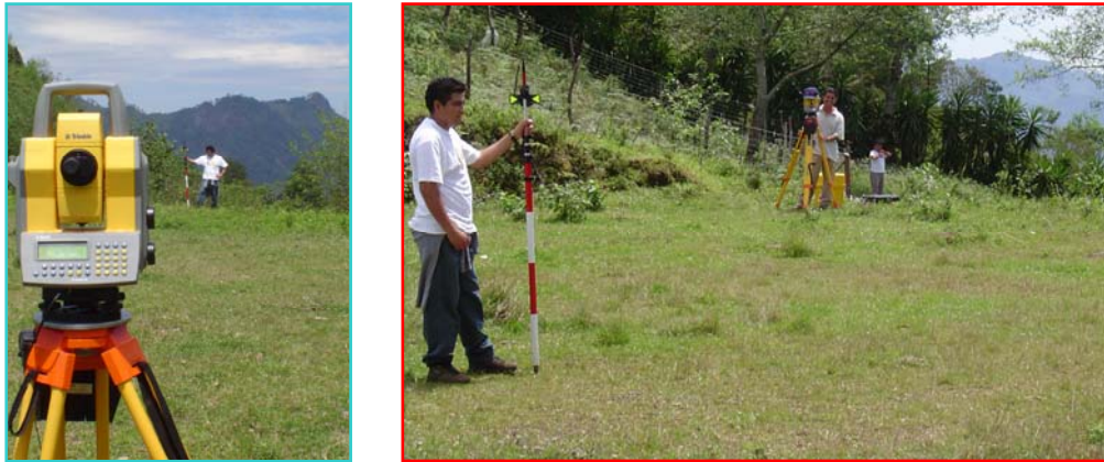
Figura 3.3 Estación Total Trimble 5600 empleada en el levantamiento topográfico
