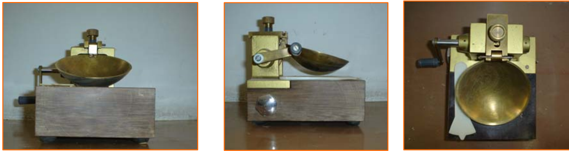
Figura 3.13 Copa de Casagrande empleada en la determinación de los límites plásticos.
