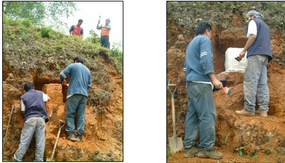
Figura 3.10 Extracción de muestra cúbica para procesar en laboratorio.
