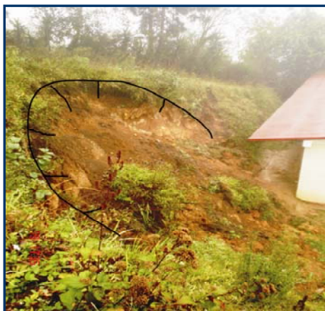
Figuras 4.9 Proceso de remoción en masa ocurrido en la ladera en estudio durante el impacto del huracán Stan en localidad de La Unión, posterior al cálculo del factor de seguridad.
