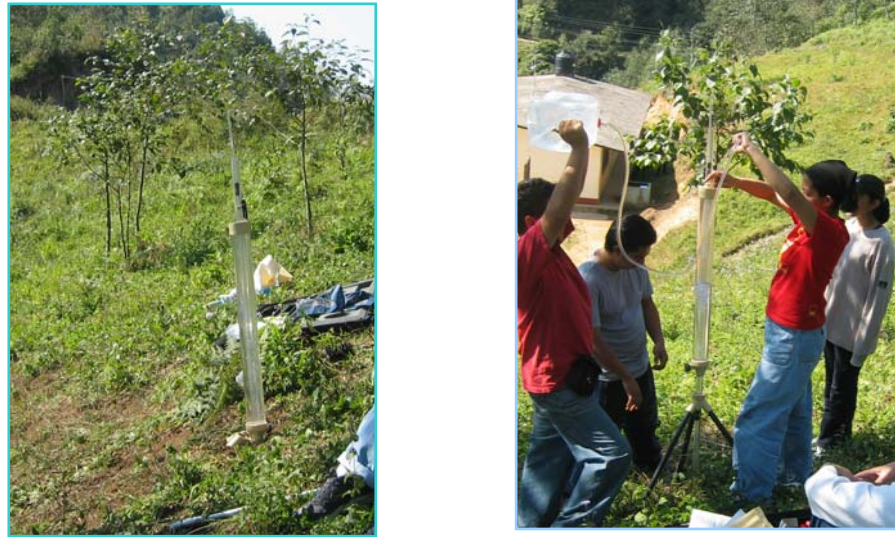
Figura 3.18 Instalación del permeámetro Guelph en la parcela experimental.
