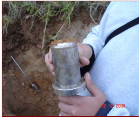
Figura 3.16 Extracción de muestras de suelos para calcular la densidad real y la aparente.
