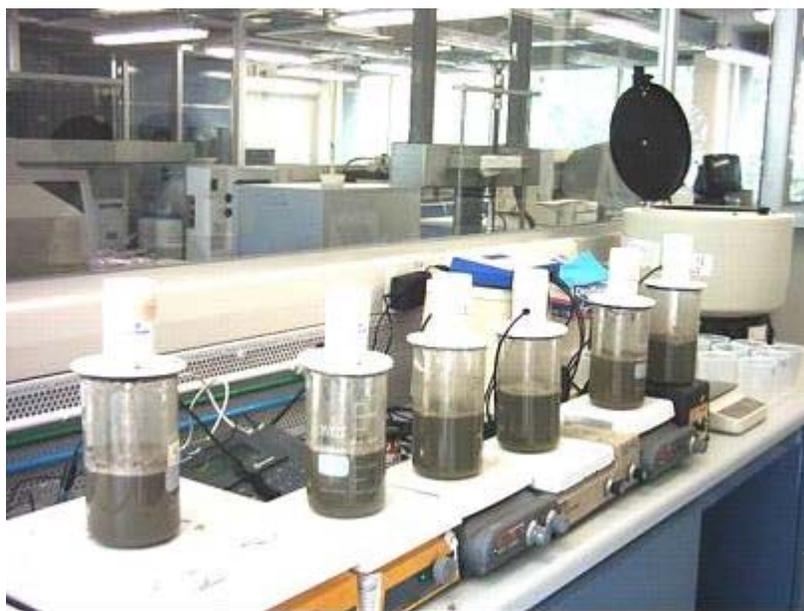
**Figura 2.3 Prueba de desinfección de lodo fisicoquímico en un equipo de prueba de jarras**
