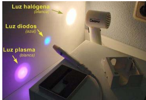
Color original de la luz emitida por cada una de las lámparas.
