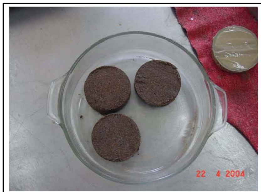
Fig.4.5 Especímenes de ensaye (muestra de suelo impregnada)
