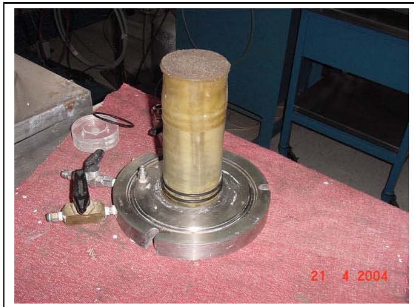
Fig. 4.4 Probeta de suelo impregnada con sílice coloidal
