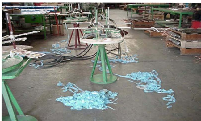
Mesa de trabajo del área de lijado del departamento de Embobinado alta tensión, la cinta en el piso es el recubrimiento retirado de la cinta de fibra de vidrio
