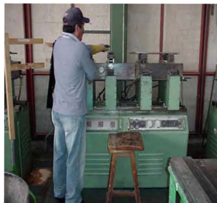
Máquina platina utilizada para la fundición de las soleras que daran lugar a las bobinas
