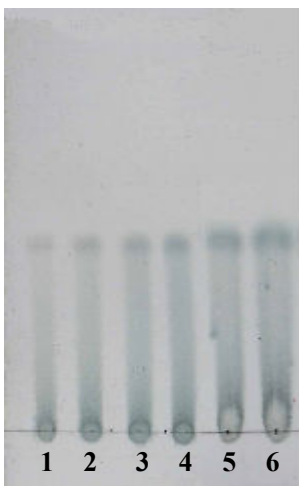
Figura 8. Cromatografía de capa fina de extractos de piña de agave desfibrado, obtenidos a 250 rpm de agitación orbital durante 6h a diferentes temperaturas. 1: inulina, 2: extracción a 25°C, 3: extracción a 40°C, 4: extracción a 60°C, 5: extracción a 80°C, 6: extracción a 95 °C.
