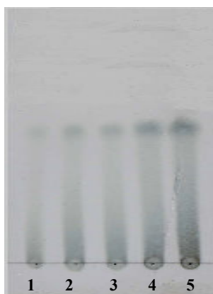
Figura 6. Cromatografía de capa fina de extractos de piña de agave de diferentes tamaños de partícula, obtenidos a 60°C y 250 rpm de agitación orbital durante 6h. 1: inulina, 2: extracto de fragmentos agave de 10mm de arista, 3: extracto de fragmentos de agave de 7mm de arista, 4: extractos de fragmentos de agave de 5mm de arista, 5: extracto de agave desfibrado.
