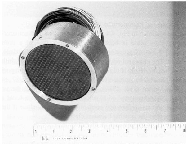
**Figura 2.5. Espejo monolítico piezoeléctrico con 345 actuadores (MPM) de ITEK.**
