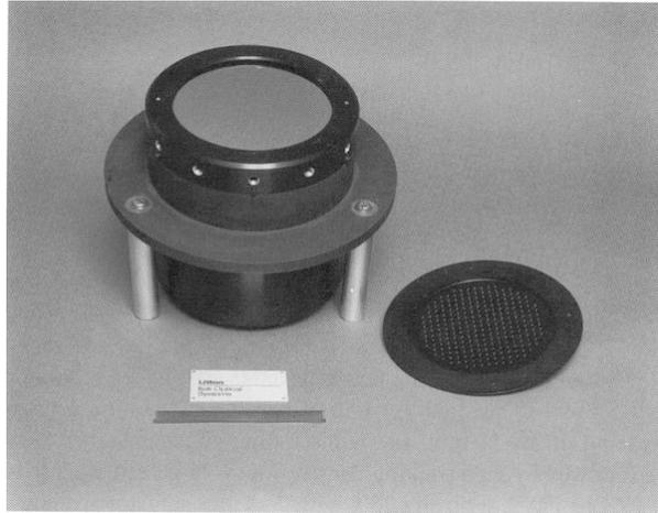
**Figura 2.6. Espejo deformable con 341 actuadores discretos (SELECT) de LITTON-LITEK.**
