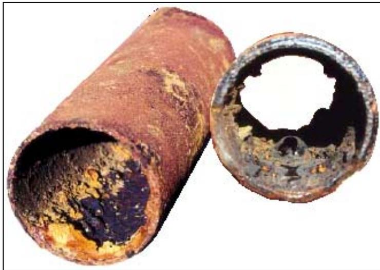
**Figura 9.** Corrosión en el interior de la tubería. Tomado de: Clarke, Bruce H. Microbiologically Influenced Corrosion. Fire Protection Engineering, 2001, No. 9, pag. 16
