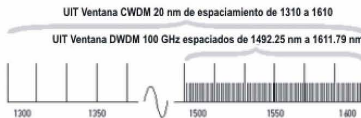
Figura 1.2 Comparación entre los sistemas WDM [1.5]
