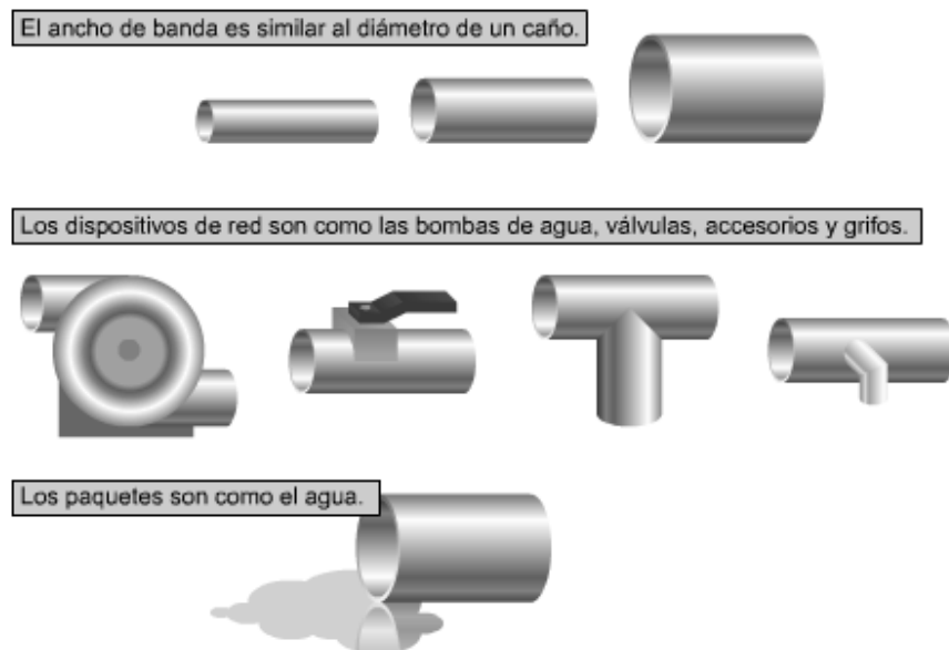
Figura 3.4. Cuanto mayor es la tubería, mayor es el promedio de fluido que puede pasar a través de ella.
