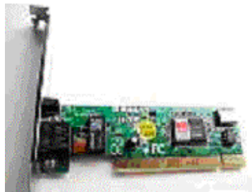
Figura 3.2. Una NIC proporciona un puerto para el acceso de la computadora a la red.
