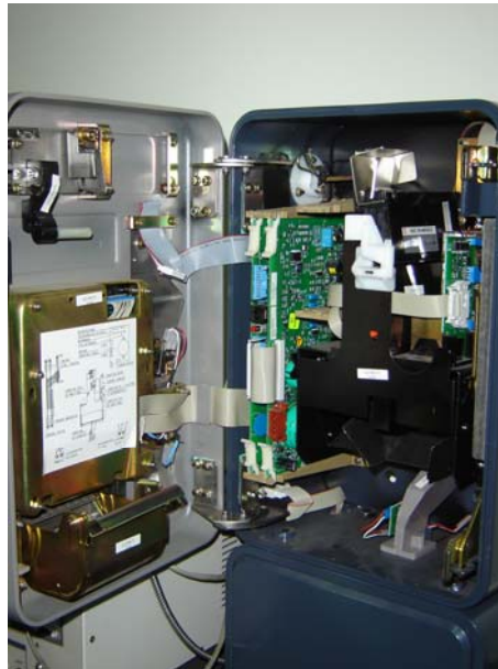
Vista Interior de Teléfono de Pruebas
