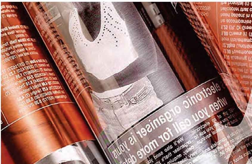
▲RODILLOS GRABADOS. Pueden girar a gran velocidad e imprimir miles de ejemplares en poco tiempo.
