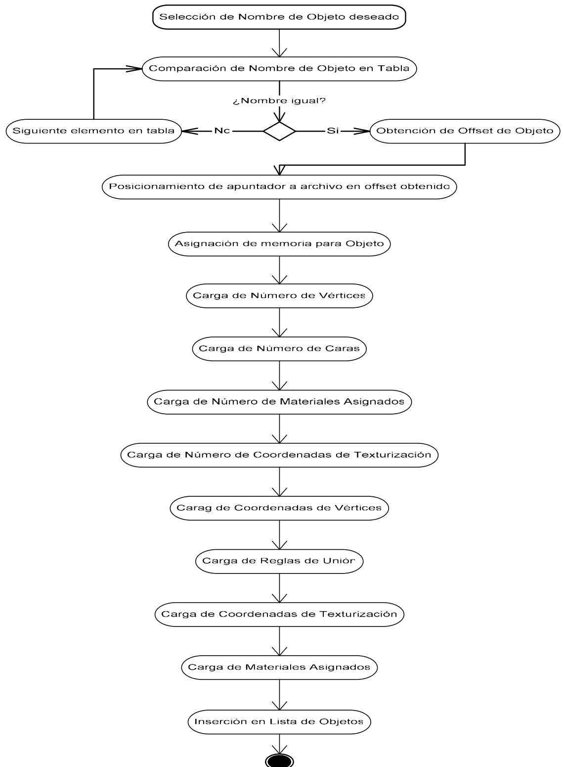
Fig. 4.4.3.1.b. Diagrama UML para lectura de datos de objeto.
