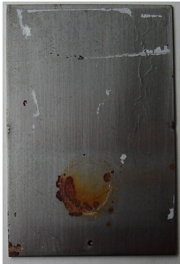
Figura 5.27 Fotografía de placa con corrosión localizada.
