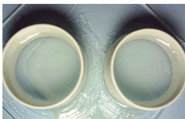
Figura 4.4. Pruebas de absorción de agua a los recubrimientos
