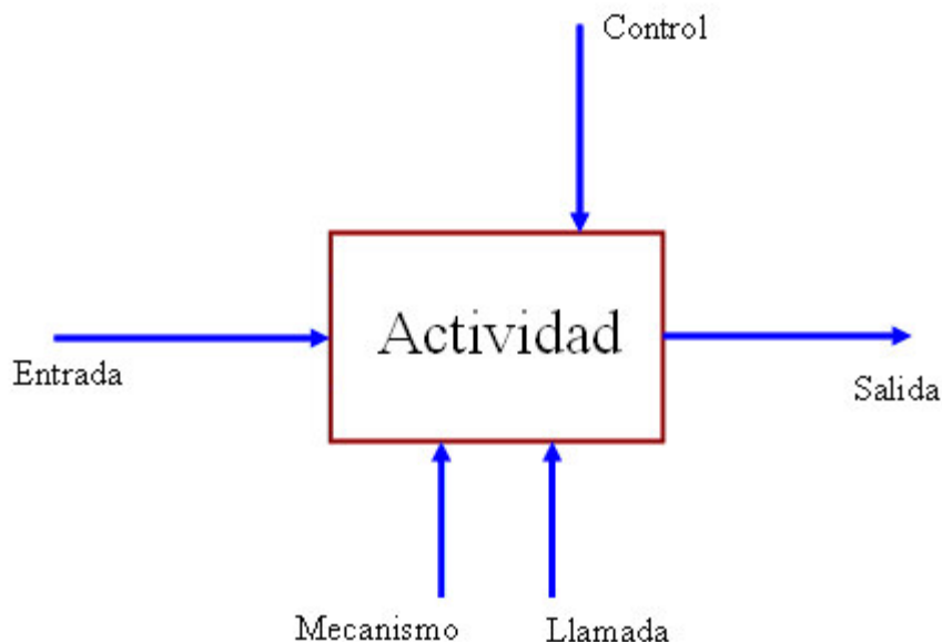
Figura1. 4. Unidad básica del sistema IDEF0
