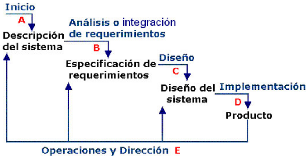
Figura 1.3. Esquema de diseño en cascada
