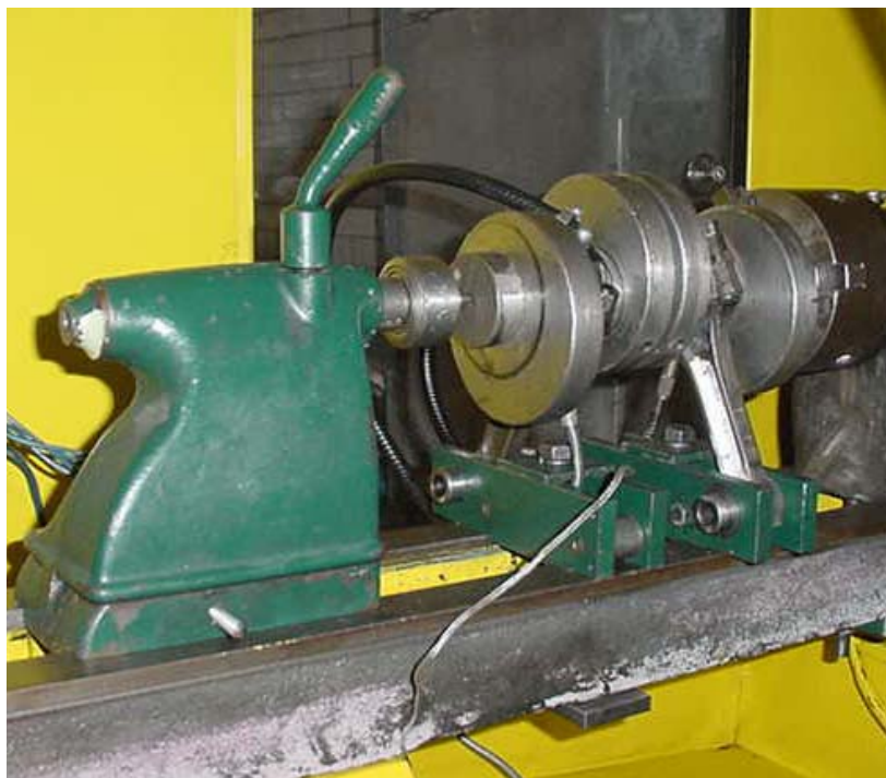
Figura 3.5 Disposición del apoyo del sistema de carga
