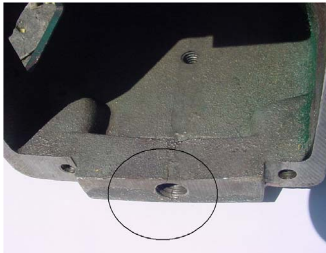
Figura 3.9 Parte inferior de la chumacera, barreno roscado para la fijación del espárrago, se observa dos grietas que corren en la sección roscada.
