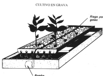
Un sistema sencillo de bandeja de grava con goteo y bombeo automático.
