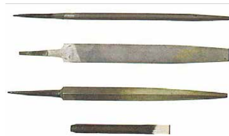
Figura 2d Limas y cortafríos útiles como herramienta de taller.
