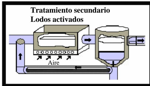
Figura 1.4 Sistema de lodos activados
