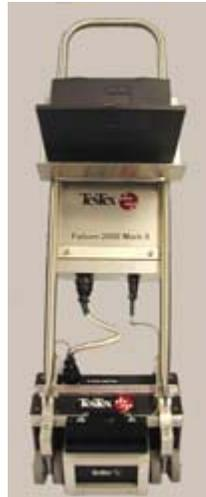
***Figura 5 Falcon 2000 Equipo que emplea Corrientes de Eddy como principio de operación.***
