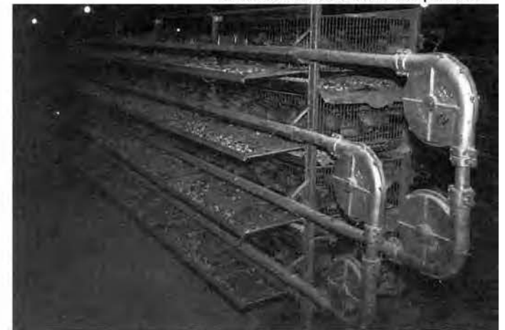
sistema automático de alimentación
