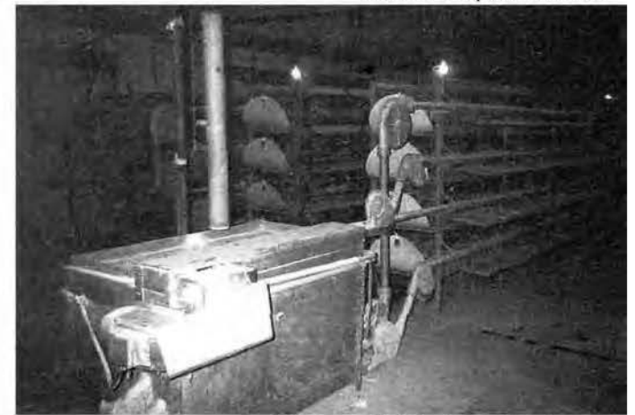
tolva suministradora de pienso
