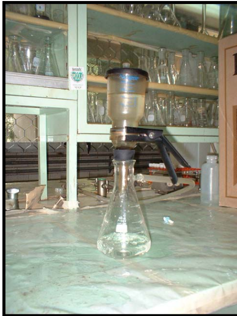
Figura B. 2 Dispositivo para llevar a cabo la filtración para la extracción de clorofila.
