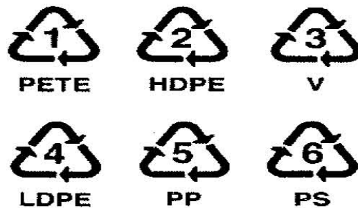
Figura 2 Norma para los símbolos utilizados en el reciclado de envases plásticos.
