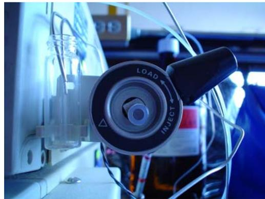
En las válvulas inyectoras, la muestra se introduce mediante una jeringa que desplaza el líquido y llena el espacio interno de una pequeña porción del tubo capilar de acero (usualmente el volumen contenido en el tubo es de 10 a 50  $\mu\text{L}$ ). La muestra se inyecta en la columna accionando la válvula de forma tal que la disposición de entrada y salida se invierte.
