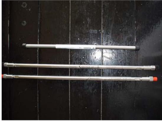
El empacado de la columna con partículas de diámetro muy pequeño requiere de una gran habilidad y un equipo muy especializado. Por esta razón es generalmente recomendado que un personal con gran experiencia en cromatografía prepare la columna. En general, las columnas utilizadas en cromatografía de líquidos son bastante durables, a menos que se utilicen de una manera intrínsecamente destructiva, como por ejemplo: eluyentes demasiado ácidos o básicos, o continuas inyecciones de material sucio.
