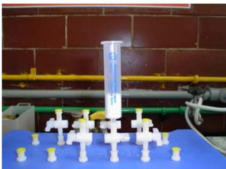
Para llevar a cabo la extracción, se utiliza un equipo de extracción al vacío en el cual se coloca la columna o las columnas (en función del número de extracciones que se realicen). El equipo es conectado a un vacío que genera presiones negativas.
