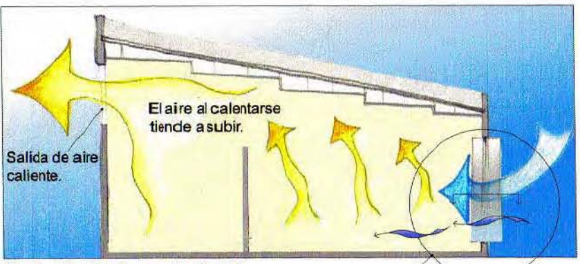
Circulación de aire en planta alta de la biblioteca.
