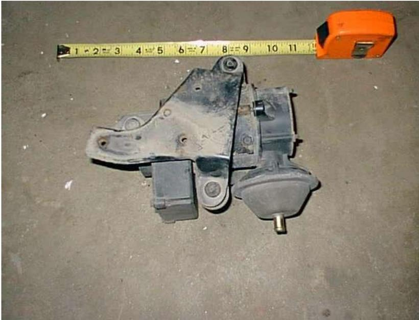
Fig 4.10 Bomba eléctrica de vacío de GM
