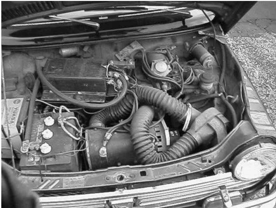
Fig. 3.3. Automóvil con propulsión eléctrica<sup>19</sup>
