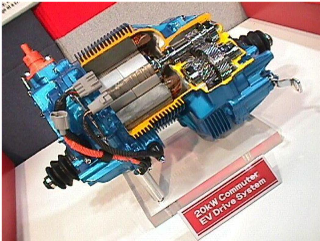
Fig. 3.19 Grupo propulsor motor- transmisión de 20 kW de potencia
