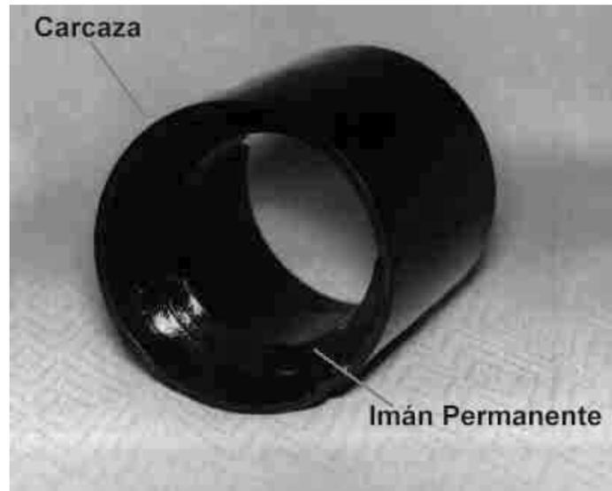
Fig. 3.5 Estator de un motor de CD<sup>8</sup>
