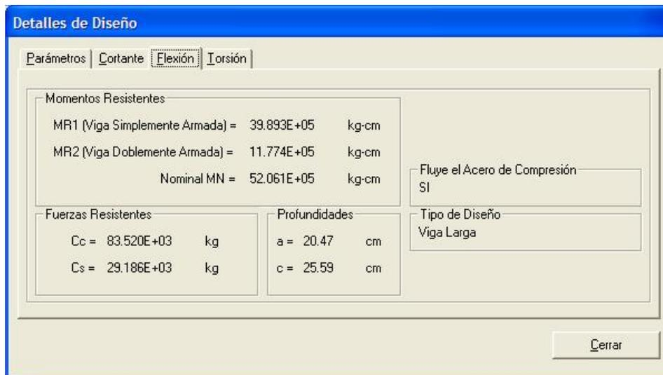
**Figura IV.75** Interfaz gráfica de usuario conteniendo las salidas de los detalles de diseño por flexión de una sección transversal de trabe de cimentación de concreto reforzado, implantada en el sistema computacional de análisis y diseño de cimentaciones *ParWin*.
