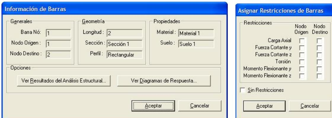
**Figura IV.54** Interfaces gráficas de usuario de edición, consulta, selección y asignación, de la información relativa a las barras componentes del modelo estructural analizado con el sistema computacional *ParWin*.
